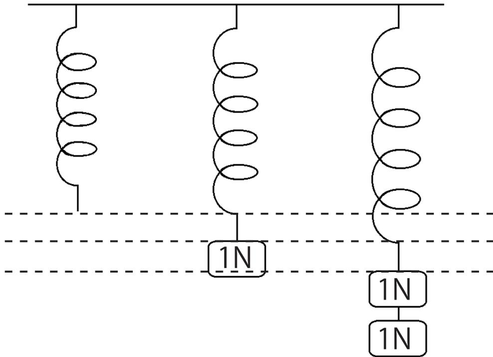
図のようにばねに加える重さ(力)に比例するのは、ばねの伸びであり、ばねの長さでは無いことに注意!!
